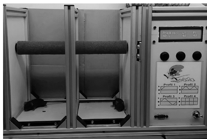
Ryc. 1. Urządzenie zastosowane w teście obracającego się wałka.
