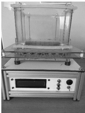
Ryc. 2. Urządzenie wykorzystane do przeprowadzenia testu koordynacji chodu na siatce z równoległych prętów.
